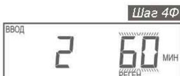
**Шаг 4Ф – Введите продолжительность второго выбранного режима (в нашем примере – *регенерация*) при помощи кнопок «ВНИЗ» или «ВВЕРХ».**
