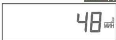
**Шаг 7Д – Расход воды, максимальный за последние 7 дней:** На дисплее появится значение максимального расхода воды (л/мин), который был зафиксирован за последние 7 дней. На дисплее выводится «0» (ноль), если не установлен счетчик воды.
