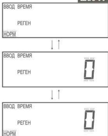
Шаг 9У – Установите параметр Режим регенерации, используя кнопки «ВНИЗ» или «ВВЕРХ» (на дисплее высвечиваются надписи «ВВОД», «ВРЕМЯ» и «РЕГЕН»):
